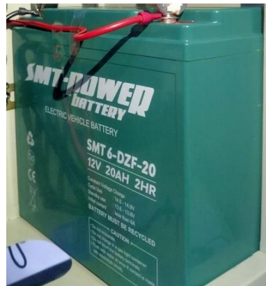
Gambar 2.3 Baterai 12 V 20 Ah
