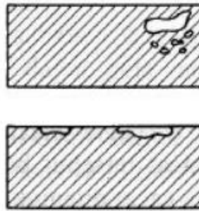
Gambar 2.4 Cacat rongga udara
