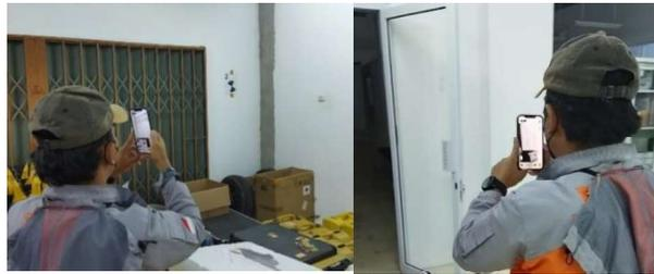
Gambar III. 3. Pengambilan data menggunakan sensor LiDAR iPhone
