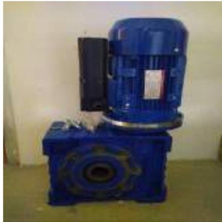
**Gambar 3. 19** Motor listrik dan gear box
