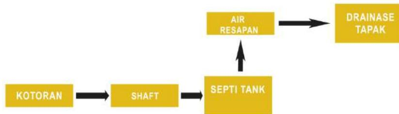
Gambar 6. 27 Sistem Pembuangan Kotoran
