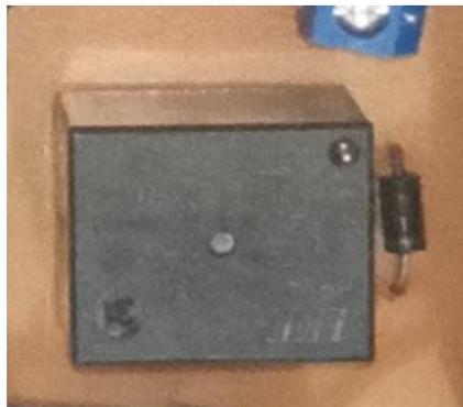
Gambar 3.18. Bentuk fisik relay 12V
