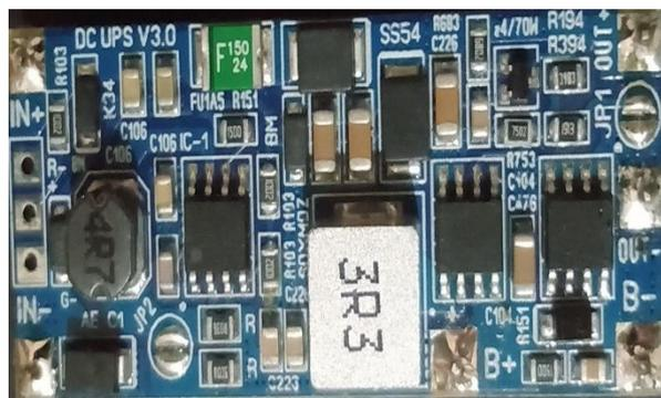
Gambar 3.14. Bentuk fisik modul UPS
