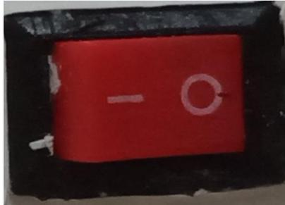
Gambar 3.20. Bentuk fisik sakelar *ON/OFF*
