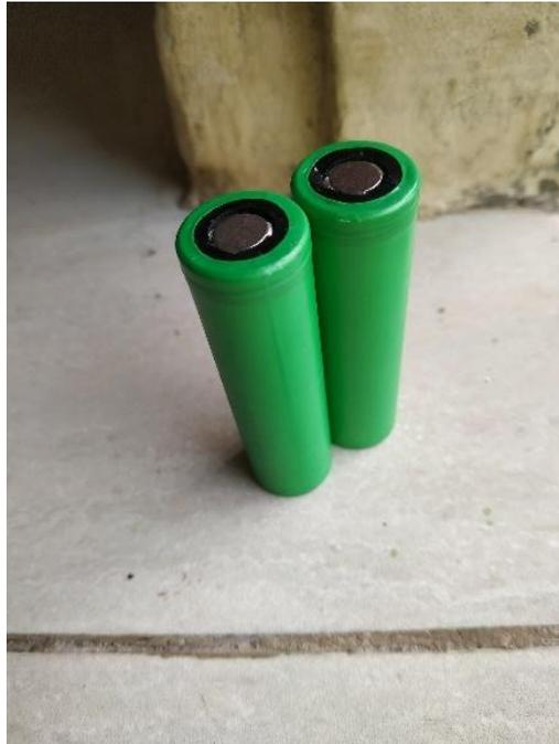
Gambar 2.6 Baterai lithium ion 18650.
