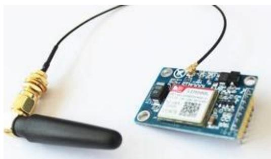
**Gambar 2. 5 Modul SIM800L v2**
