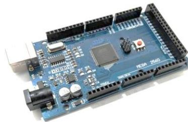
Gambar 2. 2 Mikrokontroler Arduino Mega 2560
