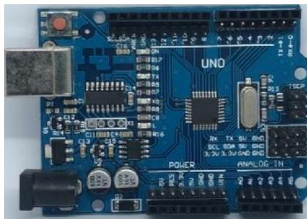
**Gambar 2. 1** Mikrokontroler Arduino UNO R3
