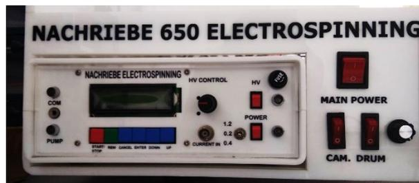
**Gambar 3.6** Tampilan depan power suplai tegangan tinggi.
