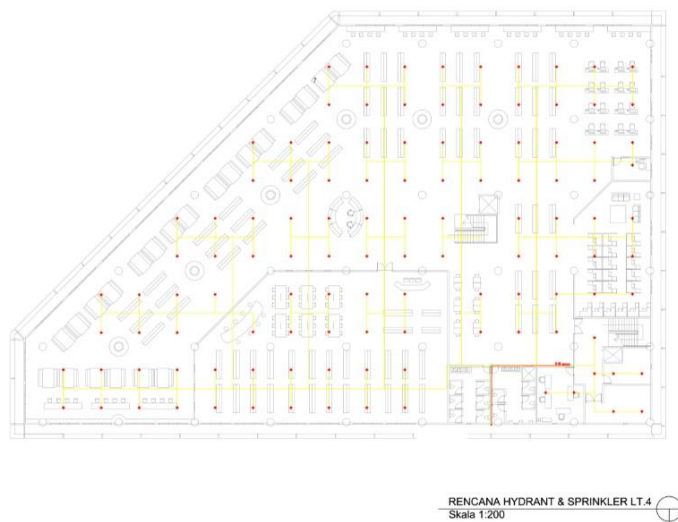
Gambar 6. 13 Denah rencana sprinkler lantai 4
