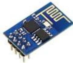
**Gambar 2. 4 Modul ESP8266.**
