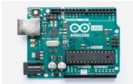
**Gambar 2. 1 Tampak fisik Arduino Uno.**
