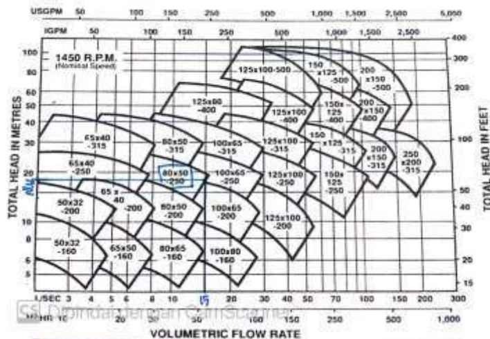
Gambar 3. Kurva karakteristik pompa
