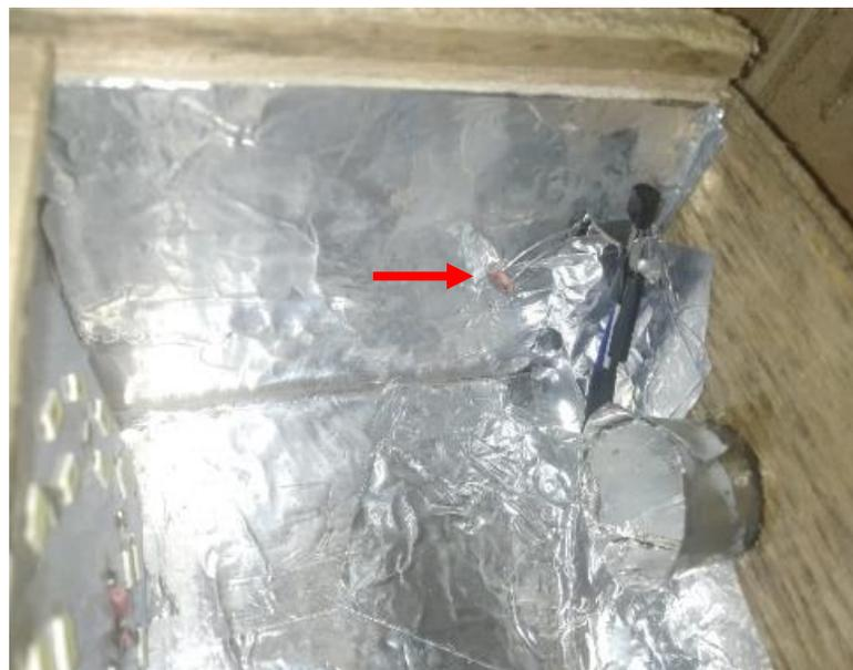
Gambar 3.10 Penempatan sensor LDR.
