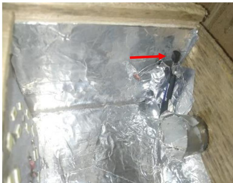
Gambar 3.9 Penempatan sensor LM35.
