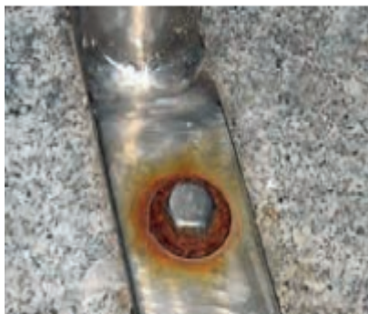
Gambar 2.2 Fenomena korosi galvanis baja karbon berlapis Zn dan baja tahan karat yang digunakan secara bersamaan [14].
