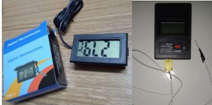
Gambar 11. Temperatur Digital dan Thermocouple Tipe k
