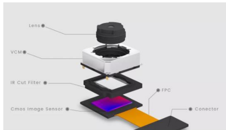
Gambar 2.6 Struktur modul kamera [6].
