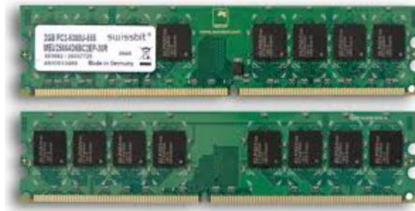
Gambar 2.3 Bentuk RAM pada komputer [2].
