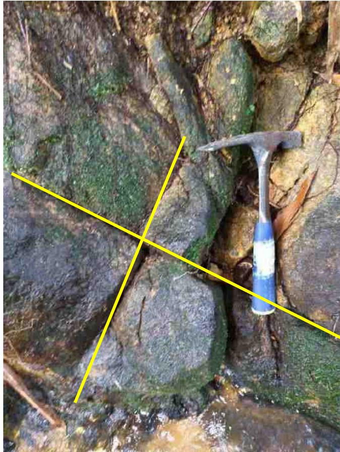
Gambar III.31. Kekar gerus berpasangan pada pos pengamatan H-4.6 dengan arah orientasi yang saling tegak lurus.
