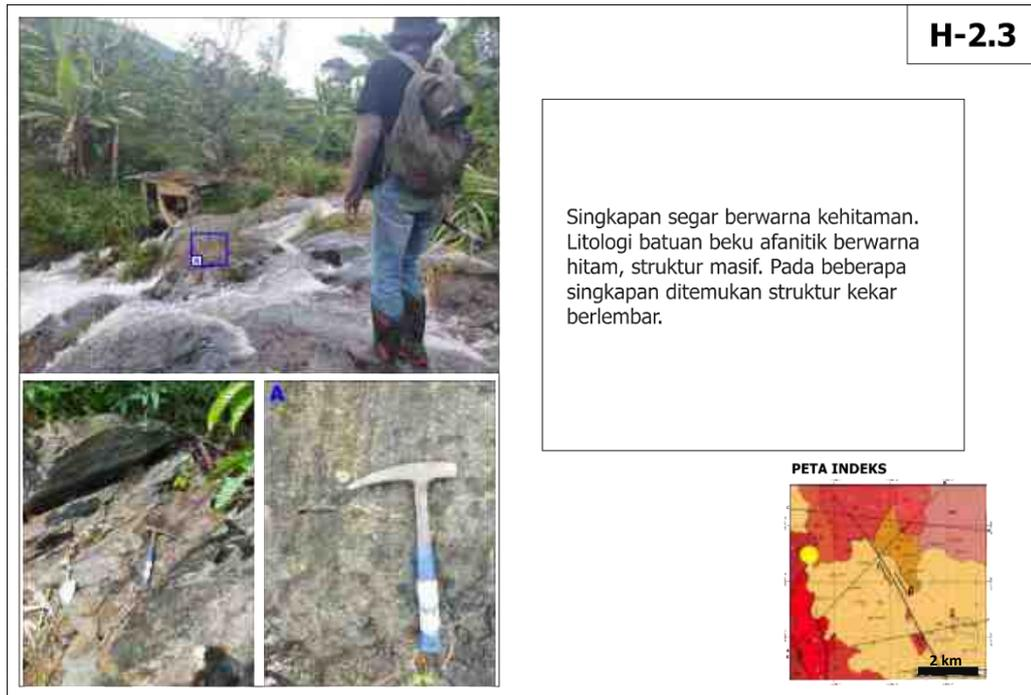
Gambar III.20. Pos pengamatan H-2.3 pada daerah Ngadiluwih tepatnya pada dinding Sungai Way Talang Suru.
