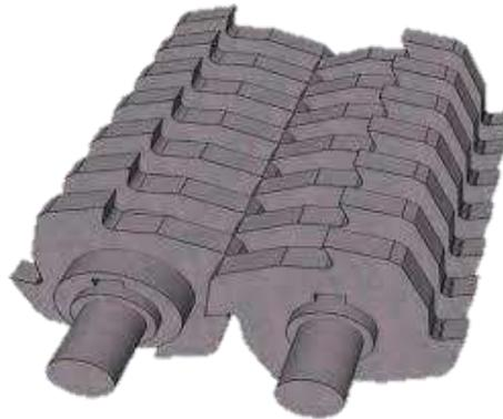
**Gambar 2. 11** Susunan bentuk mata pisau model vertikal
