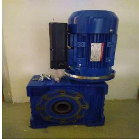
**Gambar 2. 4** Motor Listrik dan *Gearbox*
