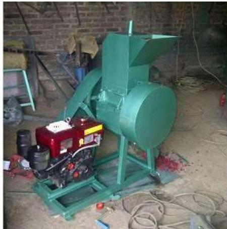
**Gambar 2. 1** Mesin pencacah plastik kapasitas 50 kg/jam
