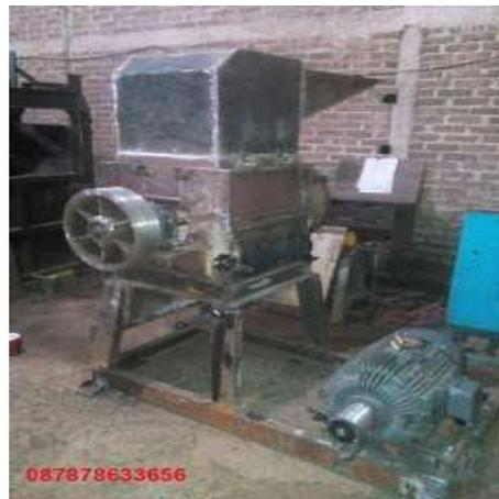
**Gambar 2. 2** Mesin pencacah plastik kapasitas 200 kg/jam
