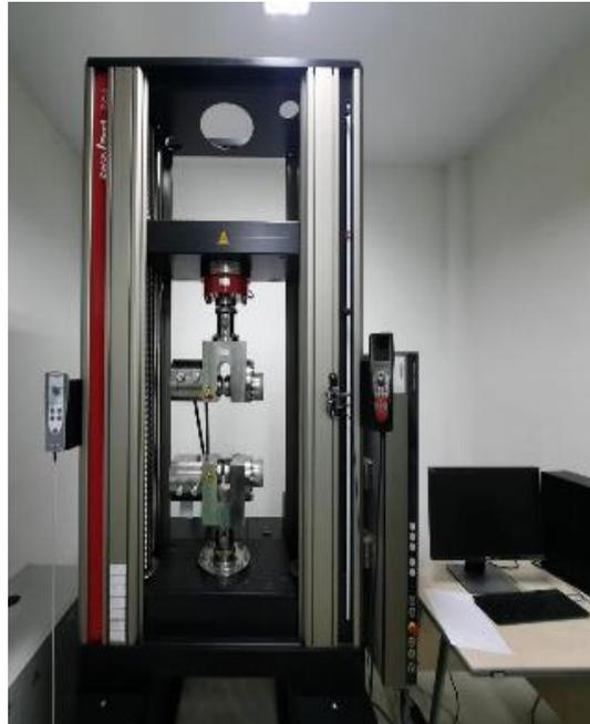
**Gambar 3.8** Alat Uji Tarik dan Uji *Bending*
