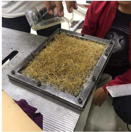
**Gambar 3.16** Proses Pembuatan Komposit
