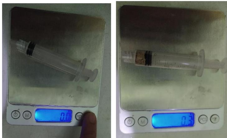
**Gambar 3.15** Proses Perhitungan Densitas Serat
