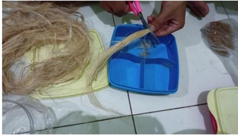
**Gambar 3.14** Proses Pemotongan Serat
