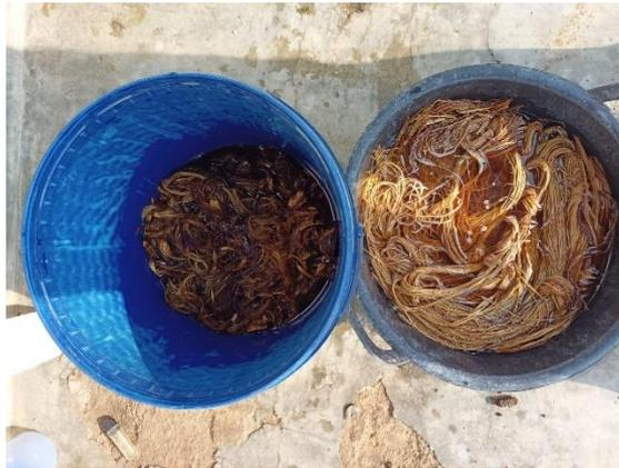
**Gambar 3.12** Proses Perendaman Serat Menggunakan Cairan NaOH 5%
