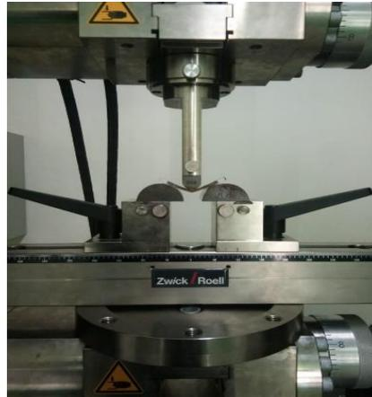
**Gambar 3.21** Pengujian *Bending* Komposit
