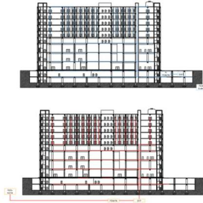
Gambar 6.16 Sistem plumbing air bersih dan kotor
