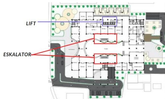
Gambar 6.11 Titik ekalator dan lift pada bangunan mall
