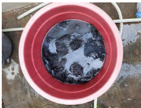
Gambar 3.10 Perendaman rambut dengan larutan 5% NaOH
