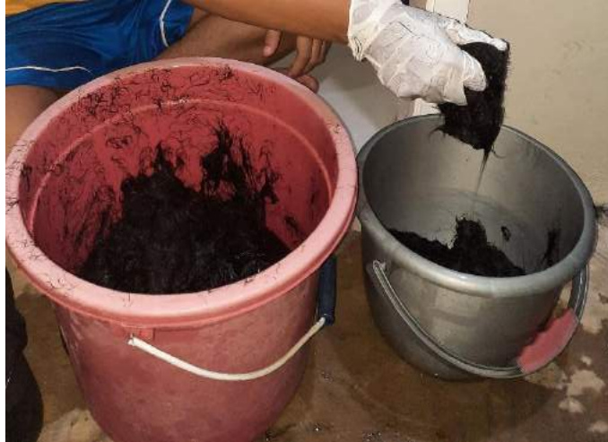
Gambar 3.11 Pencucian serat rambut
