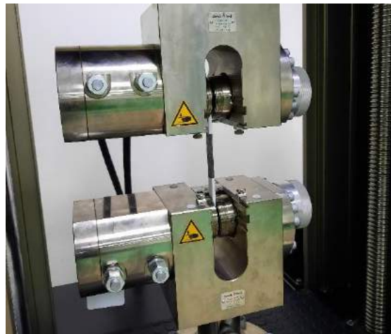
Gambar 3.19 Proses pengujian tarik komposit serat rambut manusia
