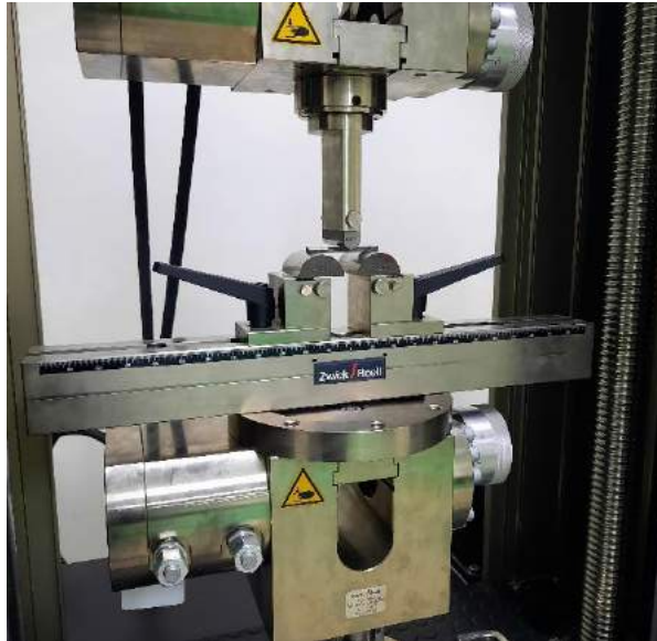
Gambar 3.20 Proses pengujian bending komposit serat rambut manusia
