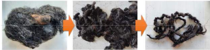
Gambar 3.13 Pembuatan serat rambut
