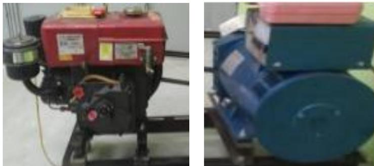
Gambar 3. 10 Mesin Diesel 4 Langkah dan Generator Listrik
