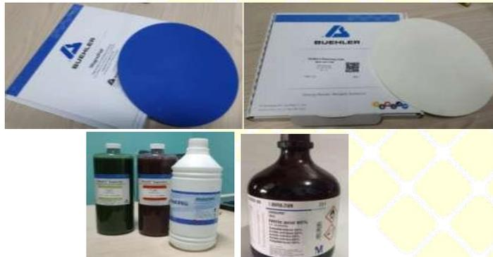
**Gambar 3. 5 *Magnopad Buehler* (kiri), *TexMet C Polishing Cloth* (kanan), Alkohol 70% dan cairan etsa**
