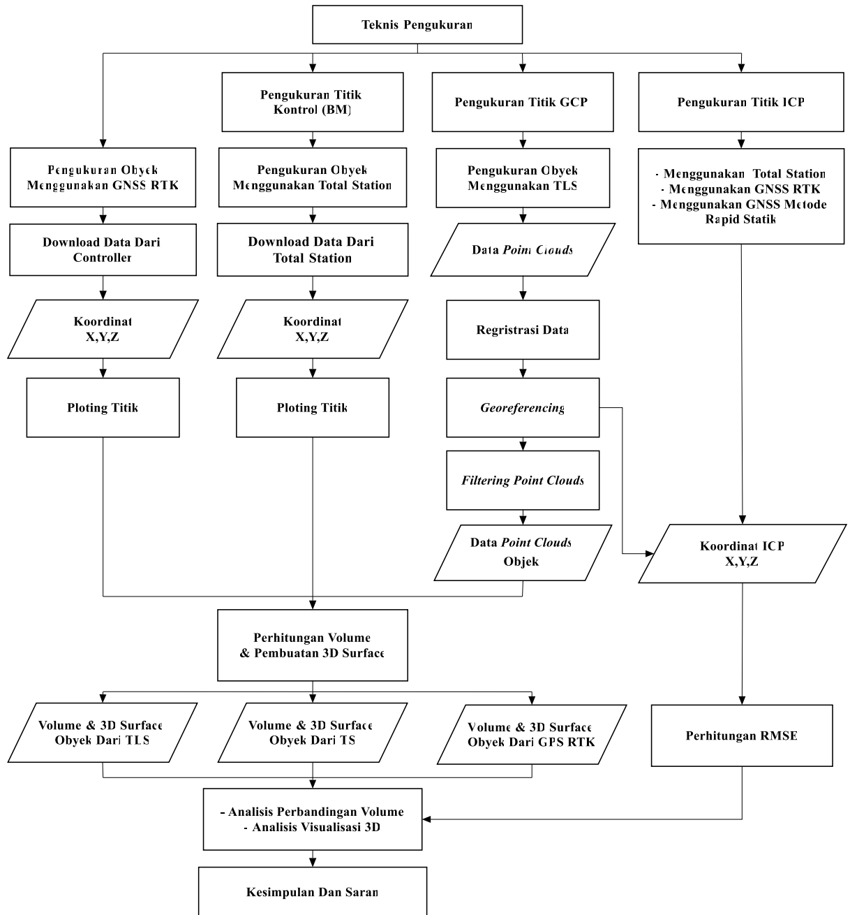
Gambar III.4 Diagram alir pengukuran dan pengolahan data
