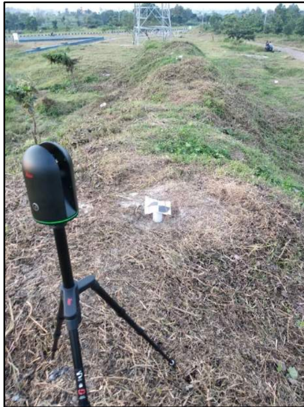
Gambar III.13 Proses pengukuran obyek menggunakan alat TLS dengan peletakan posisi alat TLS berada di dekat premark GCP atau ICP
