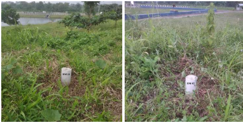
Gambar III.6 Bentuk BM di lokasi penelitian
