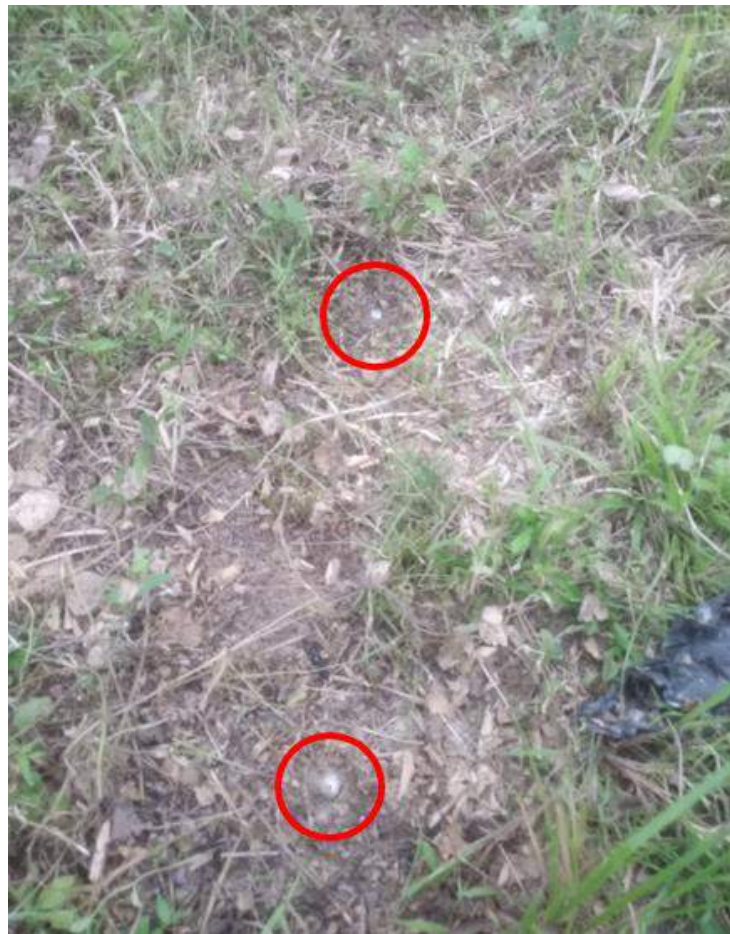
Gambar III.9 Penandaan titik detail menggunakan paku payung
