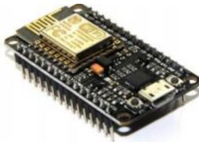
Gambar 2. 2 NodeMCU ESP8266 [9]
