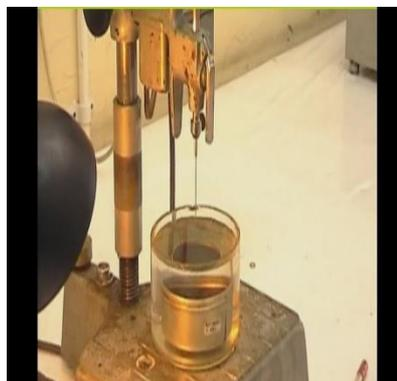
**Gambar 2.4.** Alat uji Penetrasi Aspal
