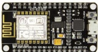
Gambar 5 NodeMCU ESP8266
