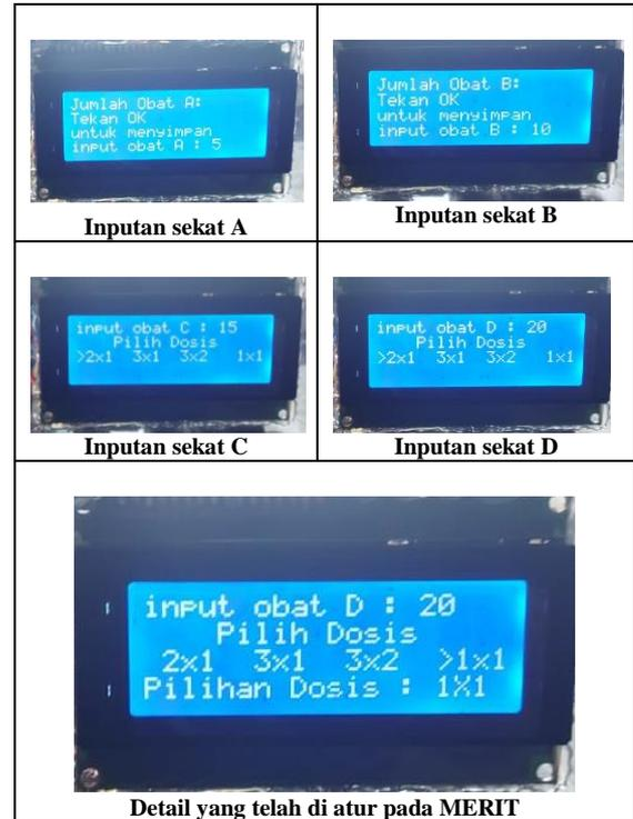
Untuk mengecek sinkron atau tidaknya antara data di *firebase* dengan mikrokontroler maka perlu adanya perbandingan antara inputan pada mikrokontroler dan keluaran pada *firebase*. Untuk keluaran pada *firebase* dapat dilihat pada tabel dibawah ini.
