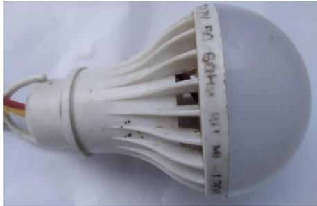
Gambar 2.10. Lampu LED MITSUYAMA MS-851 12 V DC.
