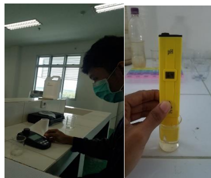
Pengujian Kekeruhan dan pH
