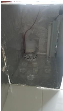
Tabung Reaktor + Lampu Uji (Lampu Pijar & Lampu UV)
