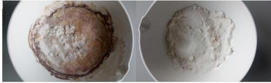
**Gambar 3.3** Abu sekam padi yang dibakar dengan *furnace*
