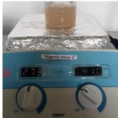
**Gambar 3.4** Pelarutan abu dengan NaOH
