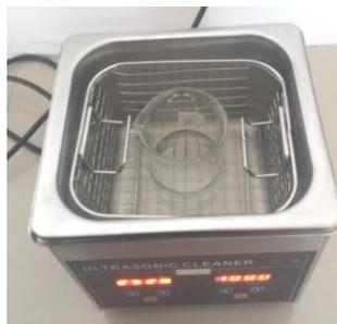
Gambar 3. 3 Proses pencucian substrat menggunakan *ultrasonic cleaner*.
