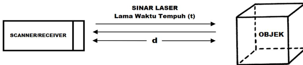
Gambar II.1 Prinsip Kerja Sensor Laser
