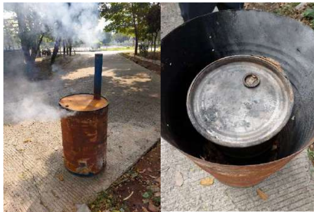
Gambar 3. 7 Alat Karbonisasi Kiln Drum
