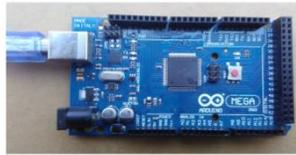
**Gambar 3.1 Mikrokontroler Arduino Mega 2560**
