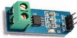
**Gambar 3.3 Sensor Tegangan ACS712**
