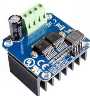
Gambar 3.10. Motor Driver BTS7960<sup>[20]</sup>
