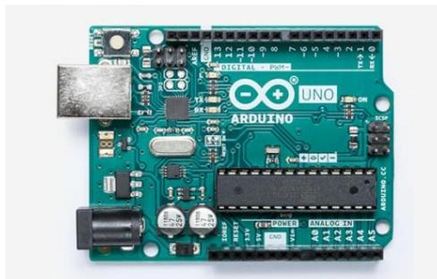
**Gambar 2. 1 Tampak fisik Arduino Uno<sup>[6]</sup>.**
