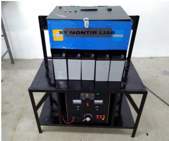
**Gambar 4.11.** Box alat *control & monitoring charge* dengan *DC-DC buck converter*
