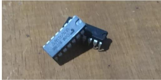
Gambar 2.2 IC ULN2003A
