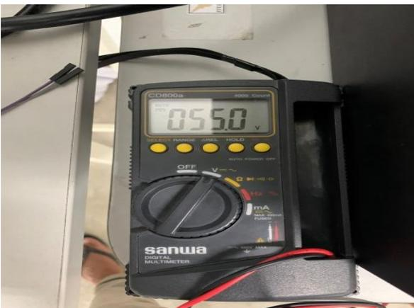
Gambar 4.4 Pengujian kapasitas baterai dengan multimeter.
