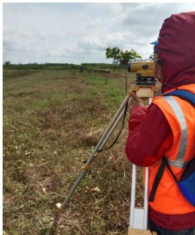
**Gambar 3.3** Pengambilan data menggunakan *waterpass*
