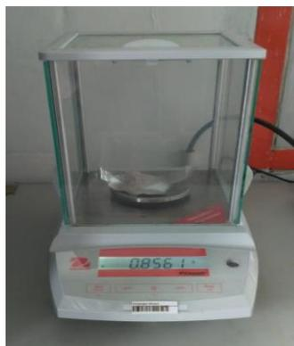
**Gambar 3. 3** Timbangan digital yang digunakan dalam penimbangan bahan.
