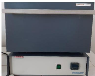
**Gambar 3. 6** Proses *sintering* dengan menggunakan *furnace*.
