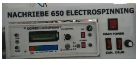
**Gambar 3.3** Power suplai tegangan tinggi.
