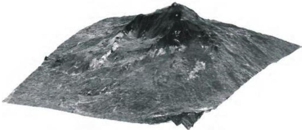
Gambar 2.15. Mount Ethna Dari Rata-rata Beberapa Sensor ERS SAR dalam bentuk DEM [2]
