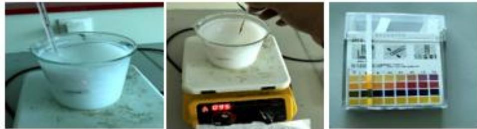
**Gambar 3. 9** Pengukuran suhu dan pH
