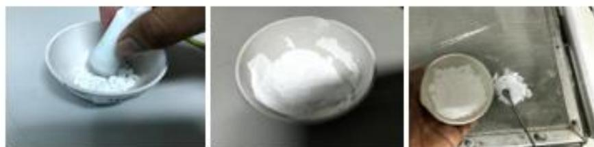
**Gambar 3. 10** Proses Penyaringan HA ukuran 36 mikron
