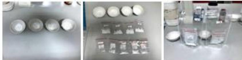
**Gambar 3. 32** Granul HA hasil sintesis siap untuk dilakukan pengujian.
