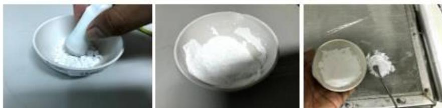
**Gambar 3. 19** Proses Penyaringan HA ukuran 36 mikron
