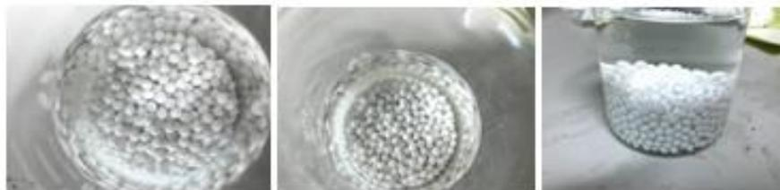
**Gambar 3. 30** Proses sterilisasi granula HA dengan etanol 96%
