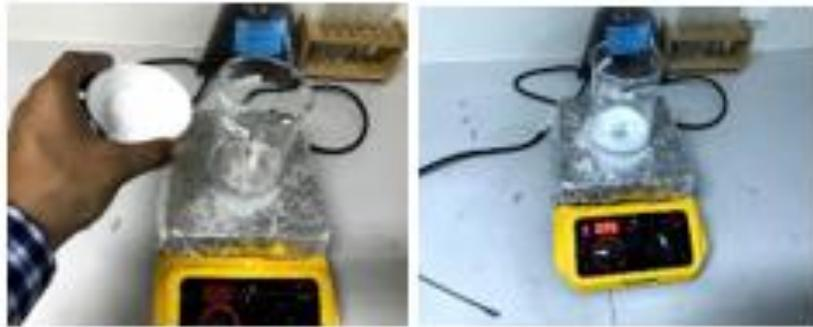
**Gambar 3. 27** Pencampuran HA dengan *alginate*
