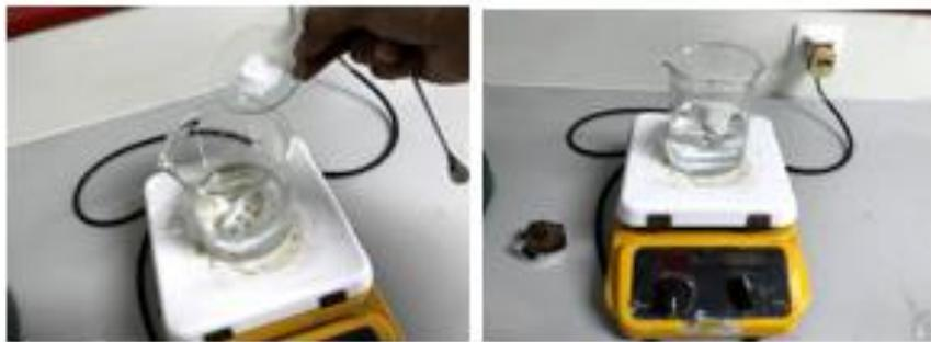
**Gambar 3. 24** Melarutkan  $\text{CaCl}_2 \cdot 2\text{H}_2\text{O}$
