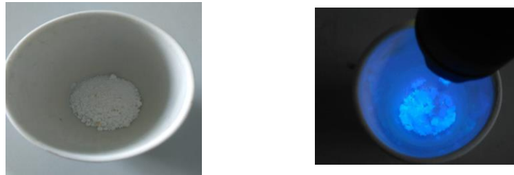
Gambar 3.7 (a) Sampel setelah melewati proses sintering (b) sampel yang disinari UV 365 nm
