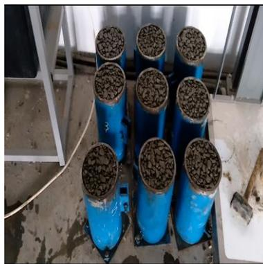
Gambar 3. 4. Pencetakan Beton
