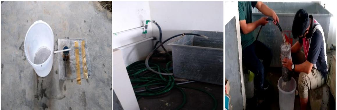
Gambar 3. 7. Alat uji porositas yang telah di modifikasi
