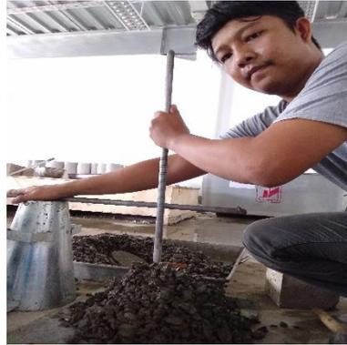
Gambar 3. 3. Pengujian *Slump Test*
