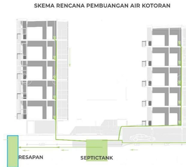
Gambar 6. 13 Instalasi air kotoran
