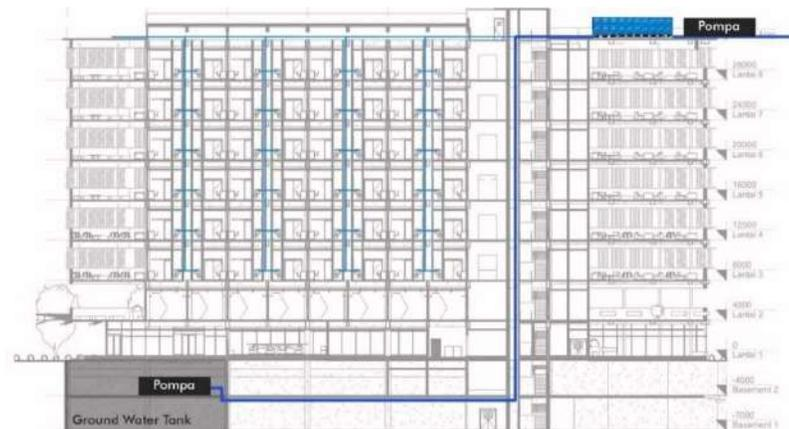
Gambar 6. 14 Skema jalur pipa *plumbing* air bersih utara
