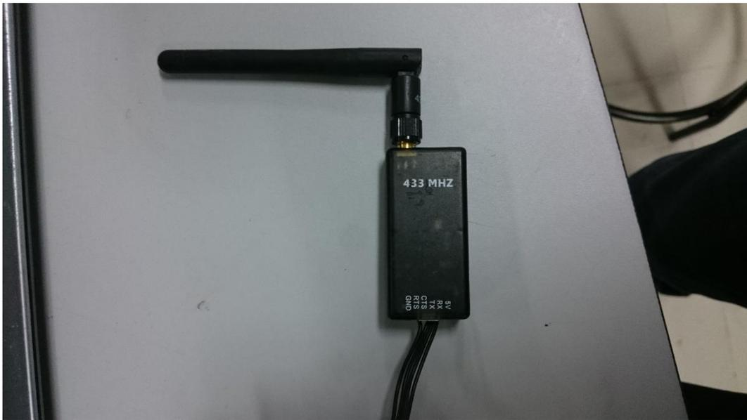
*Gambar 3 Radio Telemetry (modul receiver) dengan antena bawaan*
